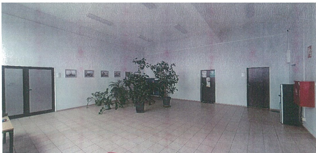
Zdjęcie nr 1 – ogólny widok pomieszczenia przed Salą Konferencyjną. Zaplanowano ułożenie okładziny podłogowej z pytek gresu oraz malowanie pomieszczenia wraz z dwukrotnym szpachlowaniem ścian i sufitu.
